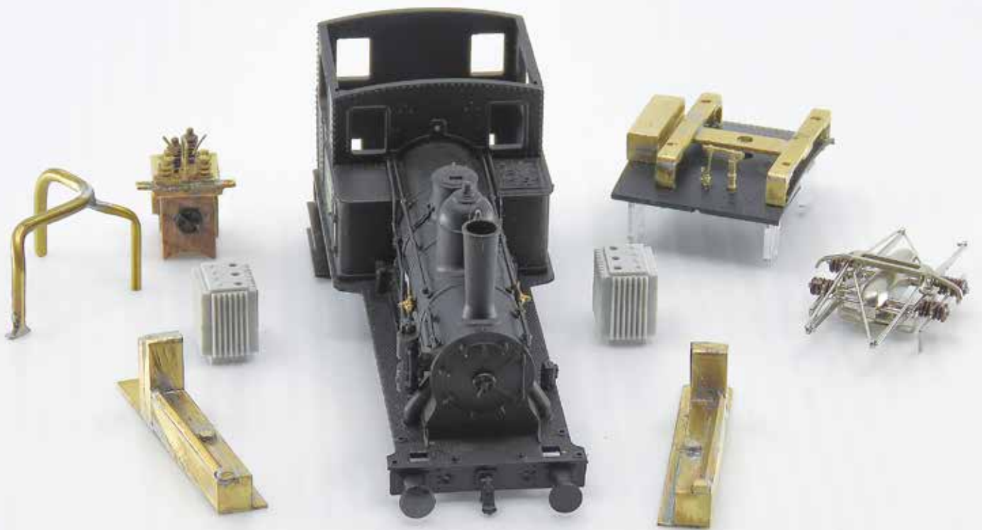
Die einzelnen Baugruppen und das Gehäuse sind bereit für die Montage. Ganz rechts der Pantograph von Sommerfeldt.
