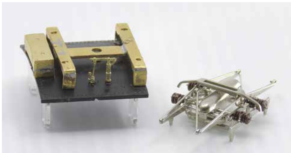
Dach mit den – noch etwas zu breiten – Trägern für den Pantographen.
