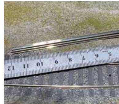
Die feinen Plättchen dienen dazu, die Löcher in den Schwellen zu schließen.
